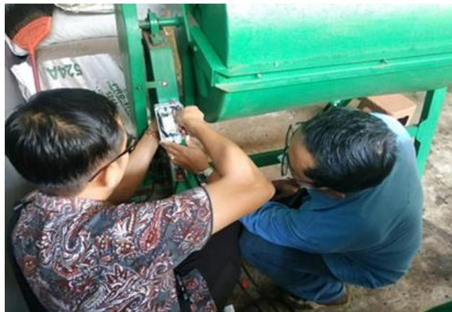
**Gambar 5. Pemasangan alat saklar otomatis pada penyangga mesin komposter**
