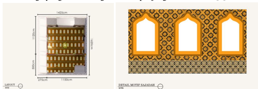
Gambar 5 Desain custom karpet yang berkonsep motif batik kawung serta dibuat dengan jarak 60cm untuk membuat physical distancing terjaga.
