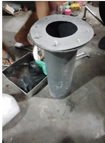
Gambar 2. Foto reaktor pirolisis yang digunakan (Sumber: dokumentasi pribadi)
