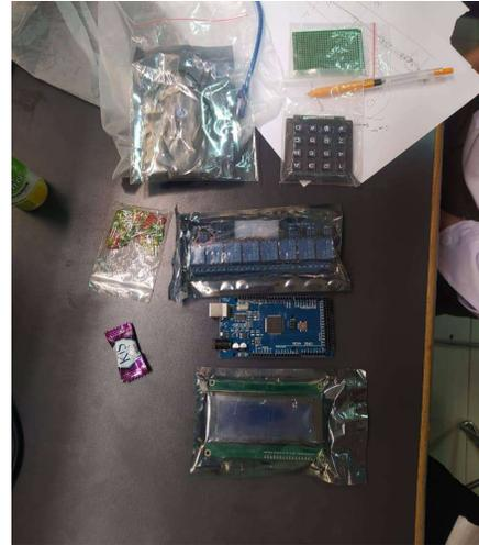
Gambar 1. Komponen Arduino kit untuk sistem penyiraman otomatis.
