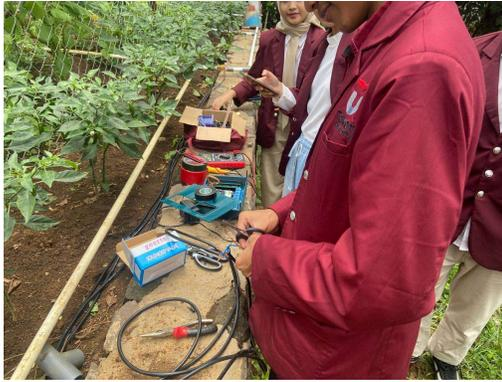
Gambar 5. Pengujian sistem penyiraman otomatis.
