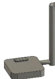
**Gambar 1.** Desain 3D Timbangan dan Stadiometer Digital
