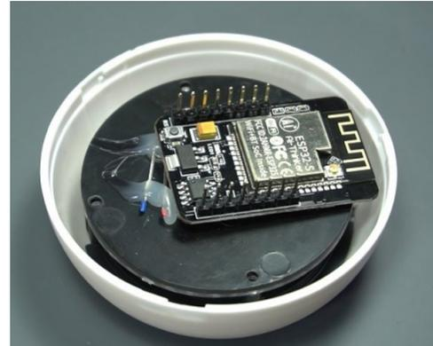
Gambar 4. Kamera CCTV berbasis ESP32cam Tanpa Case
