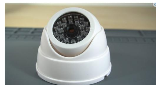
Gambar 5. Kamera CCTV Tertutup Case
