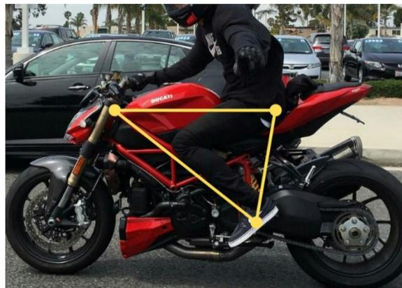
Gambar 3. Posisi pengendara saat mengendarai sepeda motor *sport*.
