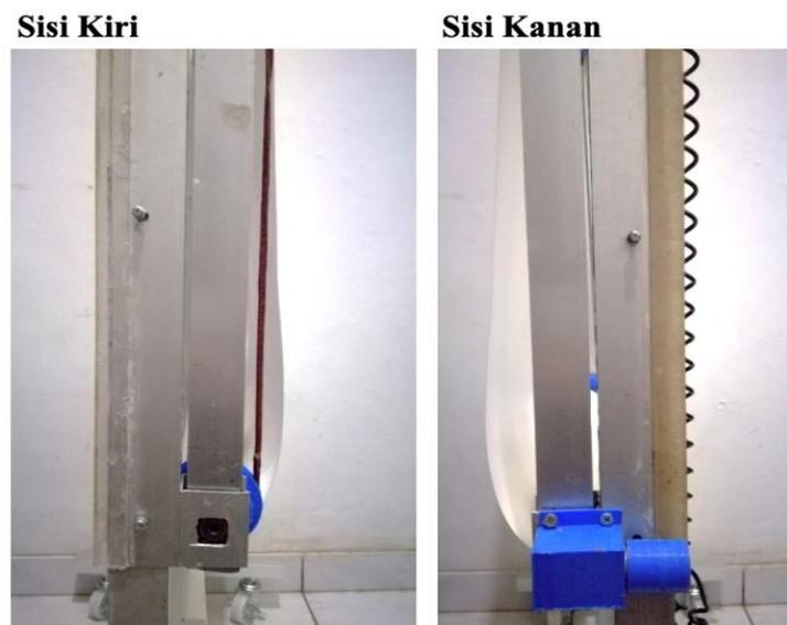
Gambar 8. Tampak samping tempat motor dengan lapisan 3D print
