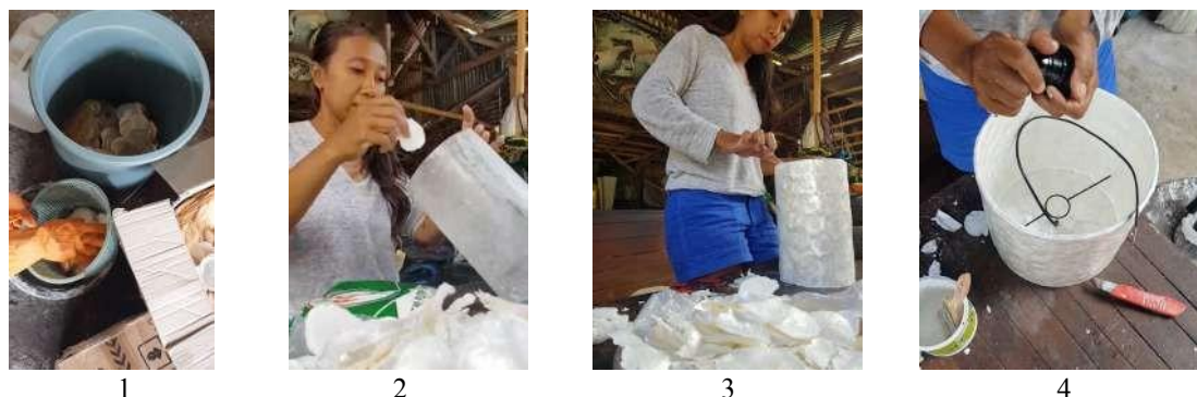
Gambar 4 Proses diawali dengan merendam kerang dalam H 2 O 2 dalam waktu yang relatif singkat (1), dilanjutkan dengan menempelkan kerang yang telah menjadi lunak pada sisi luarnya dari fiber (2 dan 3) lalu dijemur, dan pemasangan pitting lampu (4)
