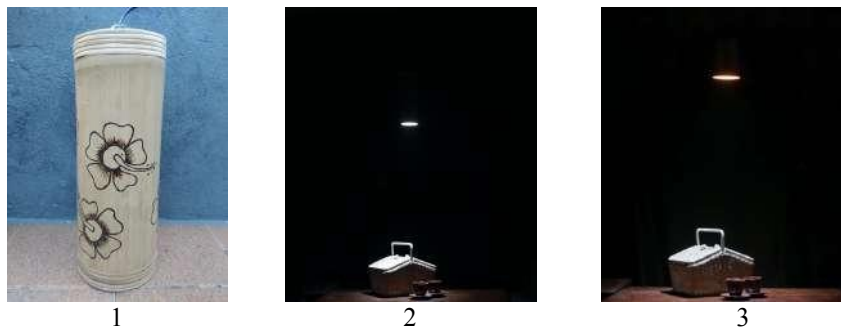
Gambar 5 : Wujud task lighting dari bambu (1) dan penerangan yang dihasilkan(2) yang dibandingkan dengan penerangan yang dihasilkan task lighting dengan kap material pabrikan logam (3)
