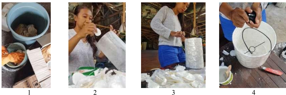
Gambar 4 : Proses diawali dengan merendam kerang dalam H 2 O 2 dalam waktu yang relatif singkat (1), dilanjutkan dengan menempelkan kerang yang telah menjadi lunak pada sisi luardan dalam dari fiber (2 dan 3) lalu dijemur, dan pemasangan pitting lampu (4)
