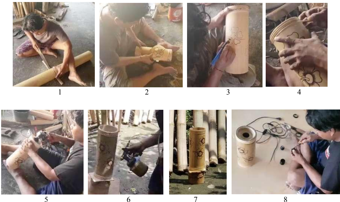
Gambar 3 : Proses diawali dengan pemilihan dan pemotongan bambu (1), dilanjutkan dengan membuat gambar dan memasang penyalin sebagai unsur estetis (2,3 dan 4), melakukan finishing dengan menghaluskan bambu (5) dan menyemprot pernis (6) lalu dijemur (7) dan memasang pitting lampu (8)
