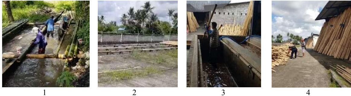
Gambar 2 : Bambu dicuci dan digosok dengan pasir sungai (1), dijemur (2), dicuci (3) lalu dijemur kembali (4)
