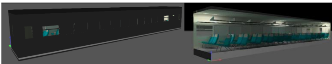
Gambar 5 : Gambaran Simulasi Pencahayaan di Kereta K1 (Kondisi Emergency )
