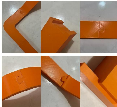
Gambar 6. Study Dummy dari track pesawat untuk mengevaluasi kekuatan dan kemudahan sistem sambungan
