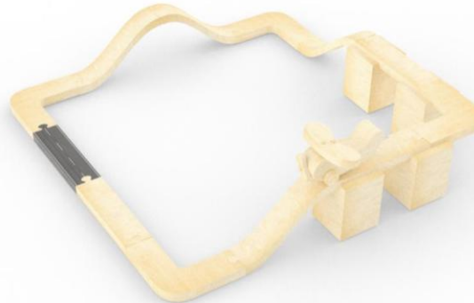
Gambar 5. 3d modelling dari track pesawat untuk melihat ketepatan ukuran
