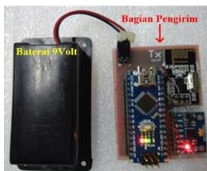
Gambar 3. Realisasi sistem bagian pengirim
