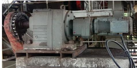
Gambar 3. Motor Induksi Fasa *Scraper Conveyor*
