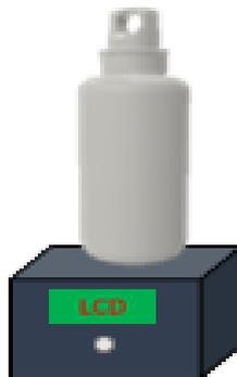
Gambar 2. Gambaran Alat Deteksi Suhu Air Pada Susu Bayi.
