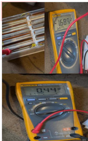
Gambar 15. Pengujian penuh Baterai dengan NaOH
