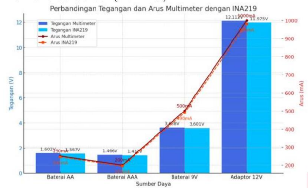
Gambar 7. Grafik perbandingan multimeter dan sensor INA 219
