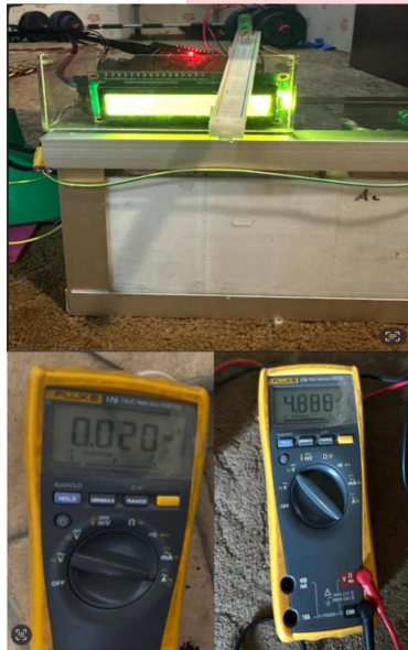
Gambar 14. Pengujian Full Baterai dengan KOH
