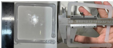
Gambar 25. Hasil Cetak Tiga Dimensi dengan Feedrate 0,5 mm/s
