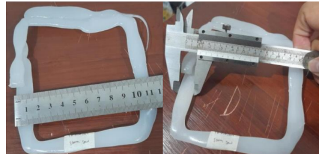
Gambar 22. Hasil Cetak Tiga Dimensi dengan Feedrate 2 mm/s
