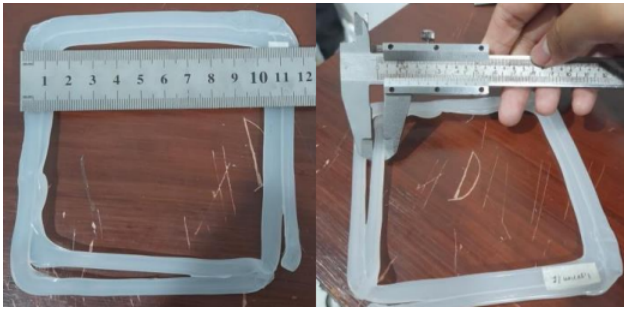
Gambar 23. Hasil Cetak Tiga Dimensi dengan Feedrate 1,5 mm/s
