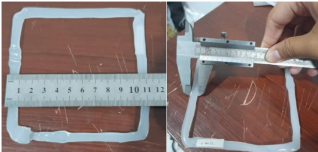
Gambar 24. Hasil Cetak Tiga Dimensi dengan Feedrate 1 mm/s
