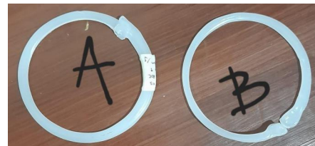
Gambar 28. Perbandingan Hasil Cetak Pengujian Sistem Kontrol Temperatur Metode PID (A) Metode On-Off (B) pada Hot End
