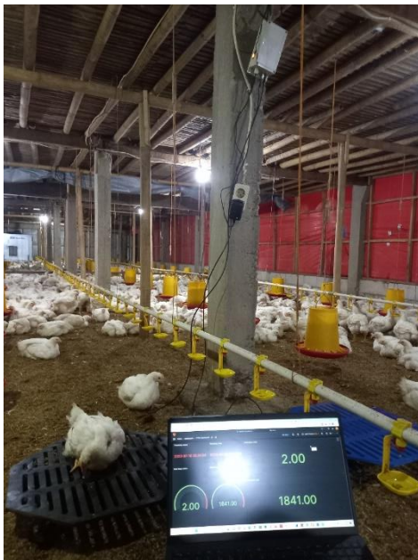
Gambar 10. Pengujian Sensor Berat NodeMCU Lolin
