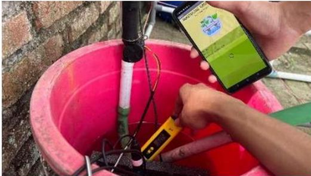
Gambar 10. Pengujian Sensor pH
