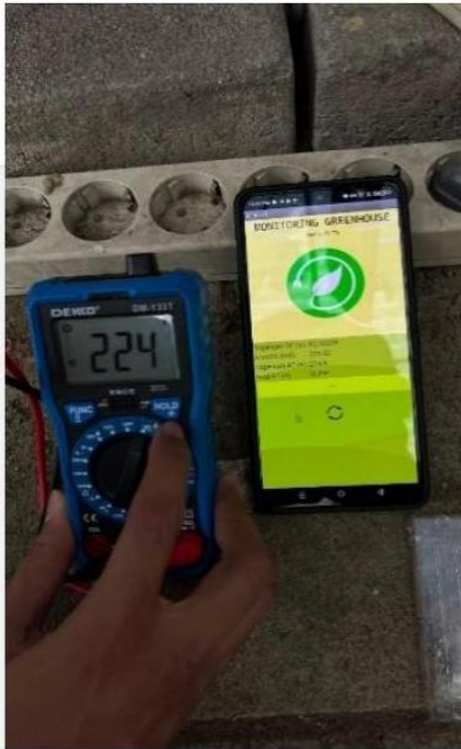
Gambar 14. Pengujian Sensor PZEM-004T
