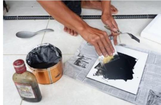
Gambar 7. Proses pengapikasian tinta cetak.
