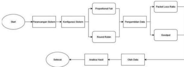
Gambar 5. Diagram Alir Perancangan Sistem.
