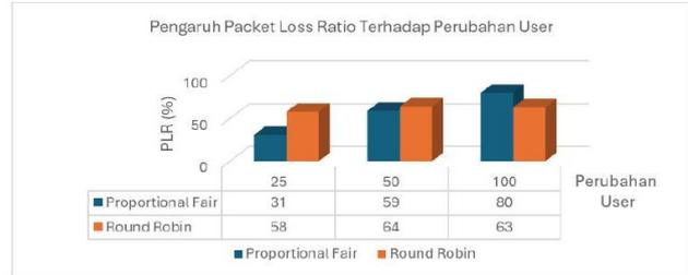
**Gambar 6.** Pengaruh Perubahan Packet Loss Ratio Berdasarkan Jumlah User
