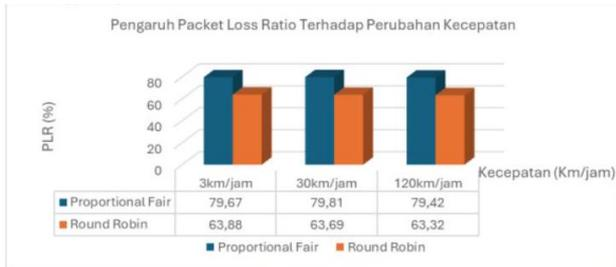
Gambar 7. Perubahan *Packet Loss Ratio* Berdasarkan Kecepatan
