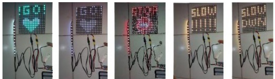
Gambar 12. Hasil eksperimen dari citra animasi pada panel LED Array dan LED strip yang terhubung dengan mikrokontroler.
