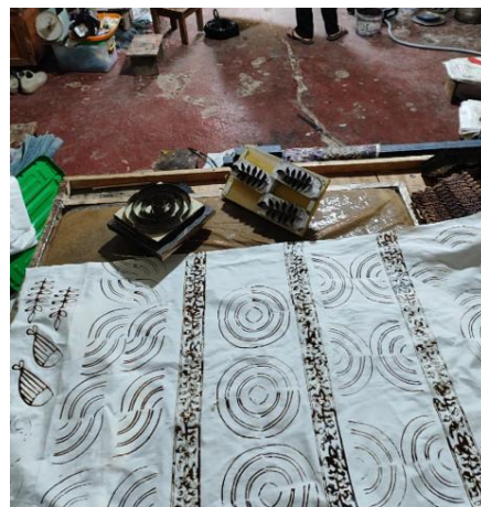
Gambar 11. Proses pengujian canting cap modular ( strong magnet ) dalam proses pembatikan. Sumber: Penulis
