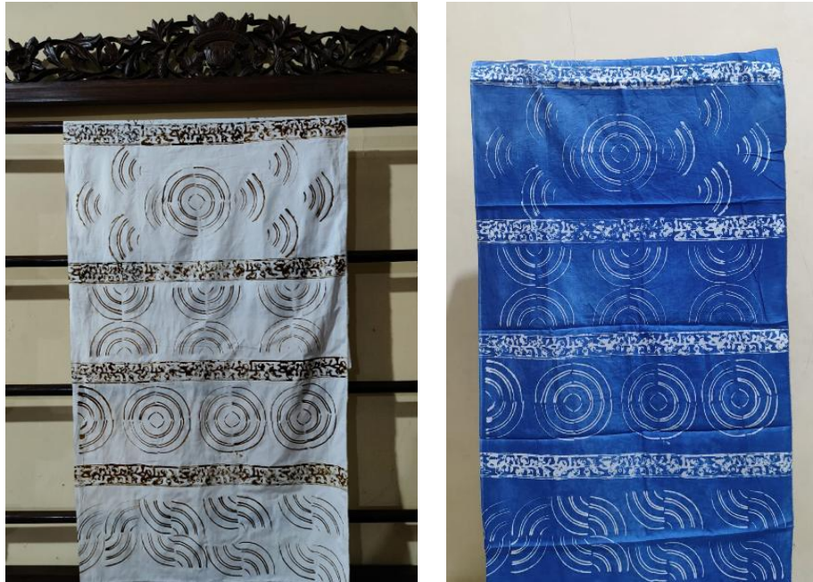
Gambar 13. Hasil pengujian canting cap modular ( strong magnet ) dalam proses pematikan. Sumber: Penulis
