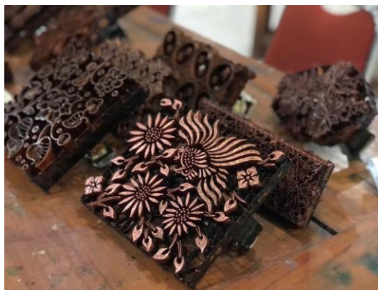
Gambar 1. Bentuk Canting Cap yang terbuat dari bahan tembaga. Sumber: Penulis
