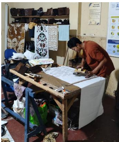
Gambar 11. Proses pengujian canting cap modular ( strong magnet ) dalam proses pembatikan. Sumber: Penulis
