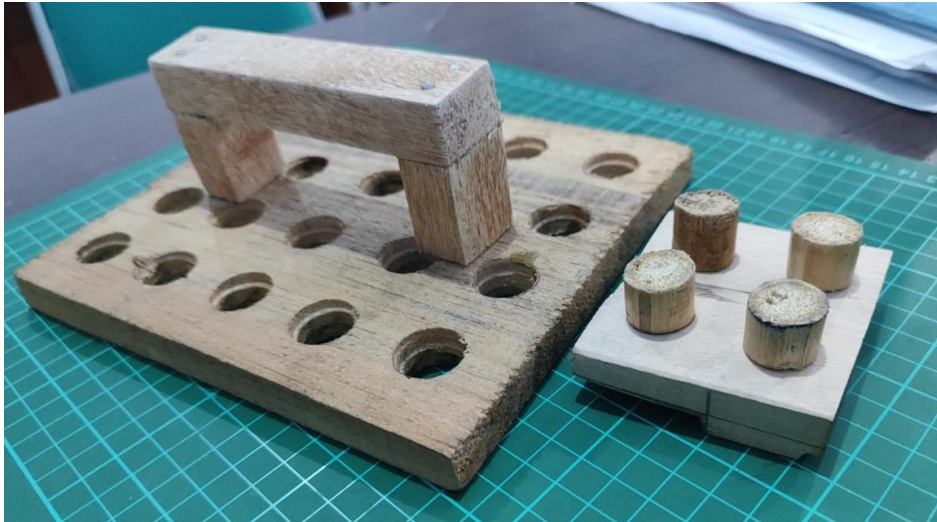
Gambar 5. Prototipe rancangan sistem modular mechanical interlocking . Sumber: Penulis
