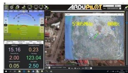
Gambar 5. Pengujian dengan ketinggian 15 m dan ukuran objek 115 cm
