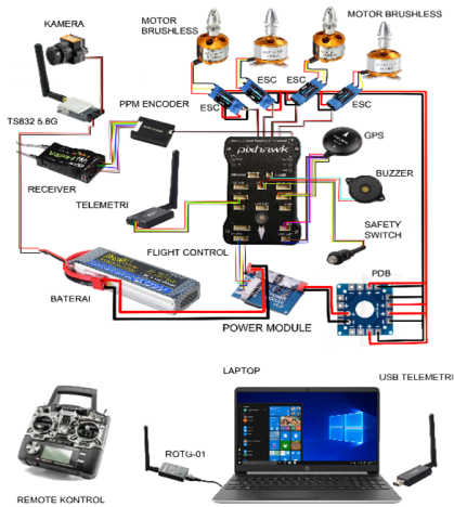
Gambar 1. Wiring prangkat keras ( hardware ) sistem secara keseluruhan
