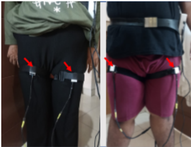
Gambar 3. Ilustrasi penempatan dua sensor MPU9025 pada kedua kaki partisipan
