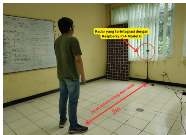
Gambar 4. Posisi Radar beserta subjek saat pengambilan data
